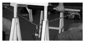
Figura 2. Colocación de la cadena en la célula de carga.
