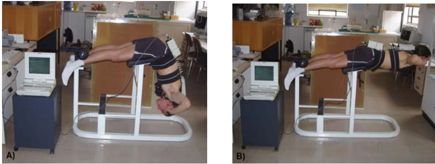
Figura 1. Disposición del Lumbar Motion Monitor (LMM) en la espalda de un participante durante el ejercicio de flexo-extensión del tronco en el banco romano. A) Posición inicial. B) Posición de mantenimiento en la horizontal.
