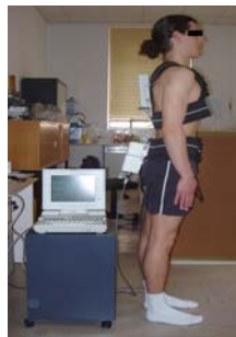
Figura 2. Disposición del Lumbar Motion Monitor (LMM) en la espalda de un participante en la posición inicial en el ejercicio de flexo-extensión del tronco en bipedestación
